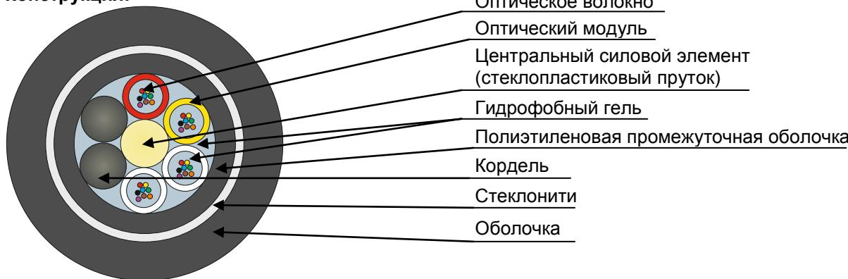
Кабель содержит сердечник модульной конструкции с центральным силовым элементом из диэлектрического стержня, вокруг которого скручены оптические модули со свободноложенными волокнами. Свободное пространство в оптических модулях и в сердечнике кабеля заполнено гидрофобным гелем. На сердечник накладывается промежуточная оболочка из полиэтилена средней плотности. На промежуточную оболочку спирально накладываются стеклонити. Поверх нитей накладывается оболочка из полиэтилена средней плотности.
